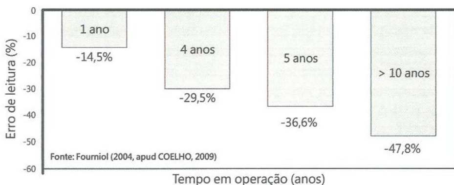
Figura 54 - Erros de medição de hidrômetros resultantes dos ensaios de hidrômetros domiciliares velocimétricos em uma rede de distribuição de Maceió sem intermitência.
