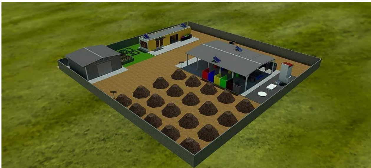
Figura 96 - Layout de usina de triagem e compostagem.
