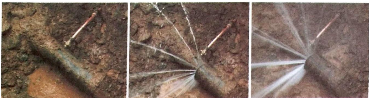
Figura 56 - Influência da pressão em um vazamento.
