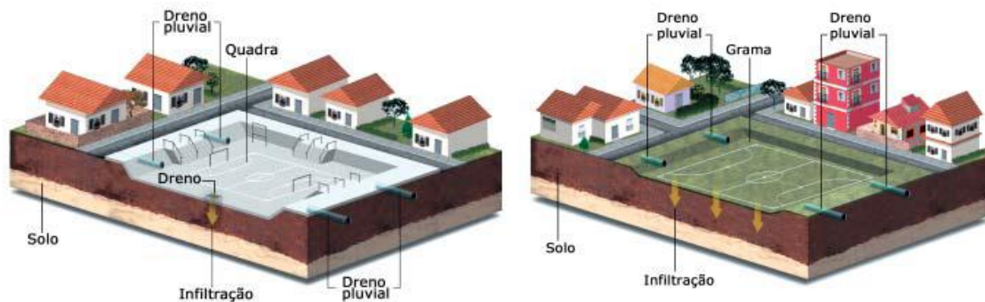
Figura 45 - Bacia de detenção em praça de esportes.
